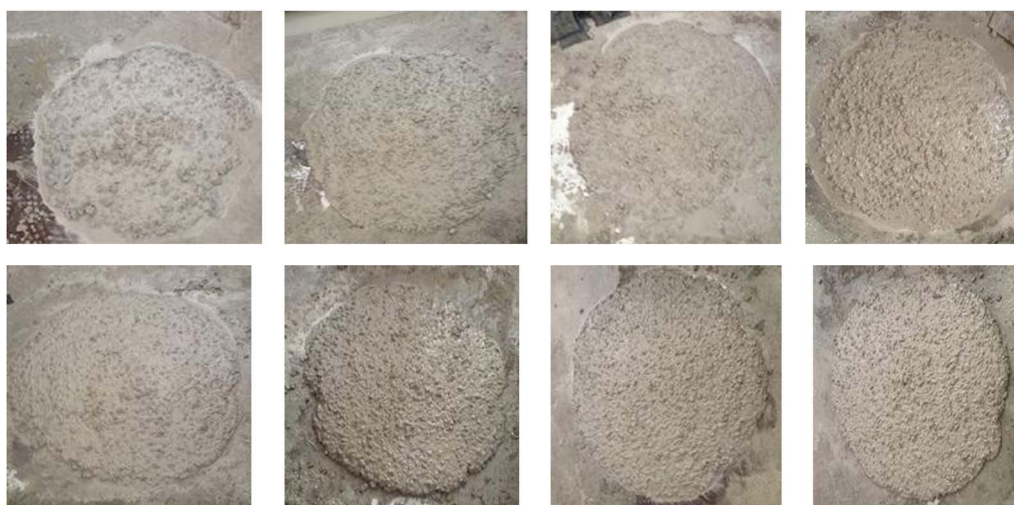
Figure 2. Comparison of workability of concrete trial mix test 1-1 to 1-8 图 2. 混凝土试配试验 1-1 至 1-8 和易性比较
