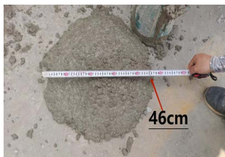
(b) 现场坍塌试验摊铺直径
