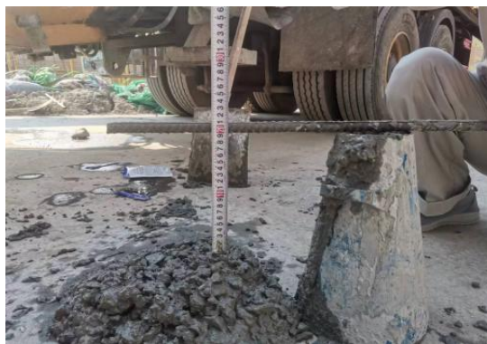
(b) 现场试验混凝土坍落度
