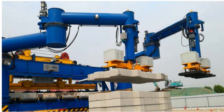
Figure 10. Paver operating 图 10. 铺路机作业展示
