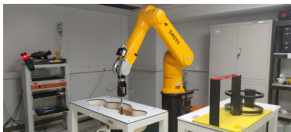
Figure 1. SAR test environment diagram 图 1. SAR 测试环境图
