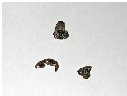
Figure 3. Failure rivet head 图 3. 失效铆钉头部
