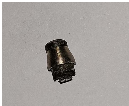
Figure 4. Rivet rod break 图 4. 铆钉杆断口
