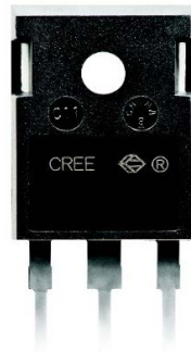
Figure 15. Second generation SiC MOSFET of Cree Corporation 图 15. Cree 公司第二代 SiC MOSFET
