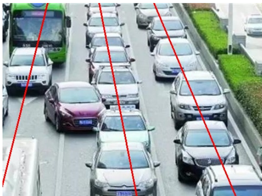
Figure 5. Lane direction straight lines 图 5. 车道方向直线
