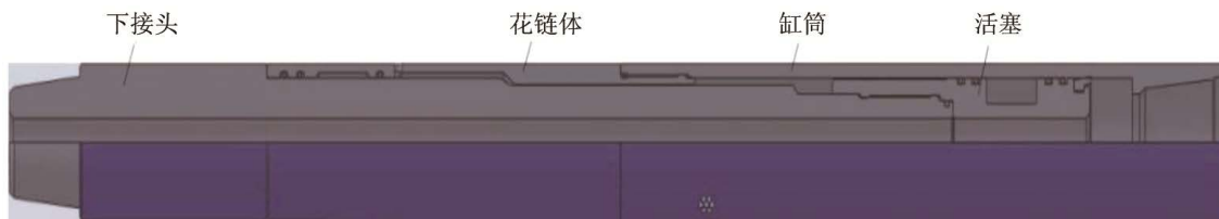
Figure 2. Composition diagram of compression damping device 图 2. 加压减震装置组成示意图
