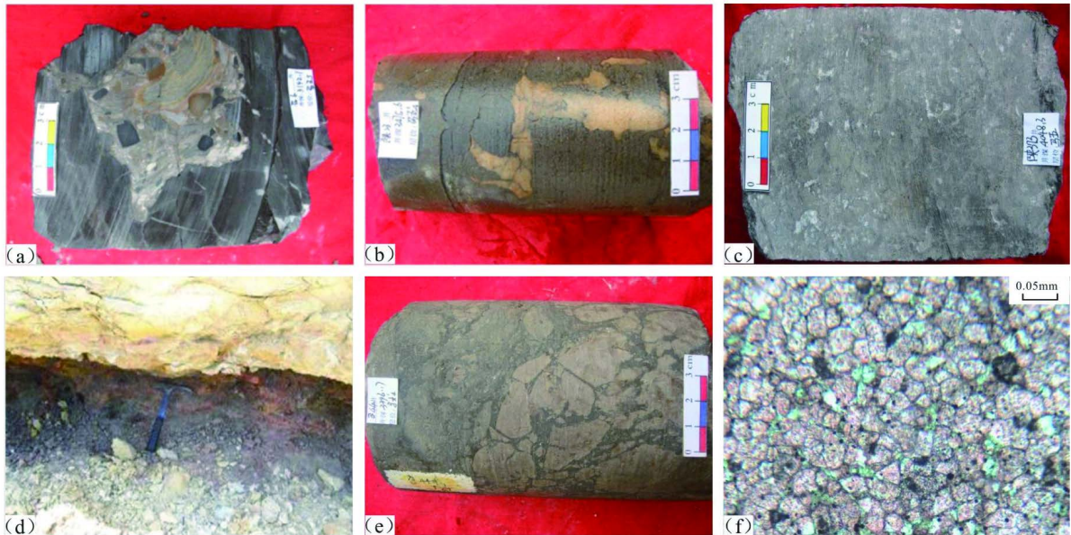
(a)岩溶洞穴充填, 召6井, 马五 1 5 , 3142.1m; (b)石膏溶蚀后充填裂缝, 陕23井, 马五 1 4 , 3475.6m; (c)溶孔上部由方解石充填, 下部由石膏充填, 陕373井, 马五 1 4 , 4048.3m; (d)马家沟组顶古风化壳, 白水三眼桥剖面; (e)溶缝、岩溶角砾, 苏29井, 马五 3 4 , 3667.77m; (f)次生方解石, 陕361井, 马五 1 (-) , 3905.85m
