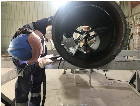
Figure 8. Picture of new argon filling method 图 8. 新型充氩方式
