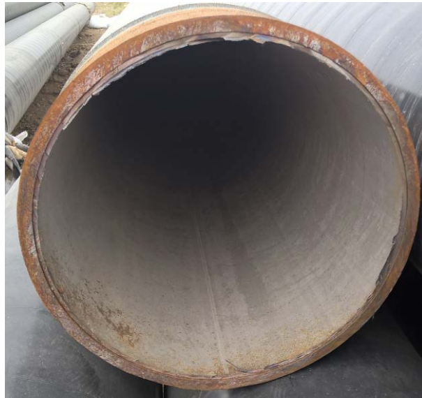
Figure 3. Gap after cutting 图 3. 切割后产生的缝隙
