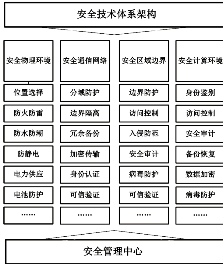
Figure 3. Industrial control network security architecture 图 3. 工业控制网络安全体系架构图
