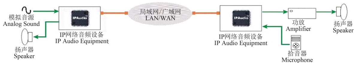
Figure 1. IPAudio™ bidirectional audio transmission maps 图 1. IPAudio™ 双向音频传输示意图
