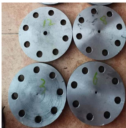
Figure 11. Leakage orifice plate 图 11. 泄漏孔板实物
