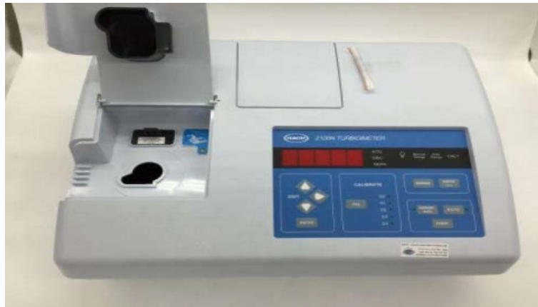
Figure 1. 2100AN laboratory turbidity tester of Hach company 图 1. 哈希公司 2100AN 型实验室浊度仪
