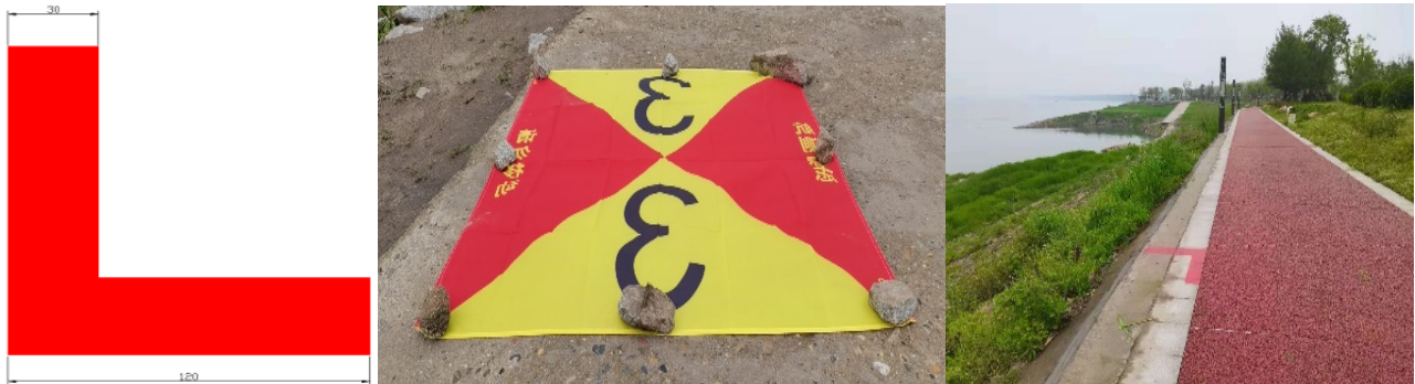
Figure 1. Image control point at land surface 图 1. 像控点人工地面标志
