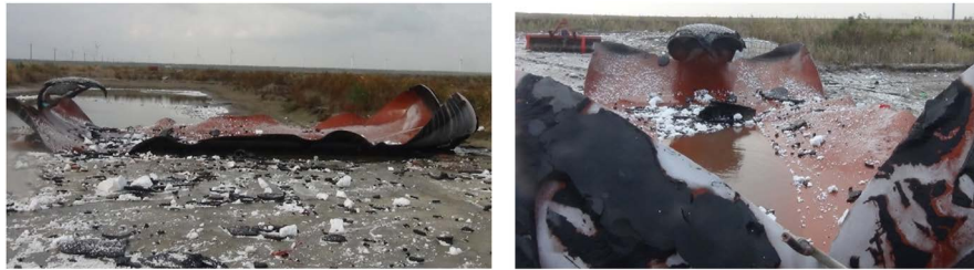
Figure 6. Overall blasting effect of the first test steel pipe 图 6. 第一次试验钢管整体爆破效果图
