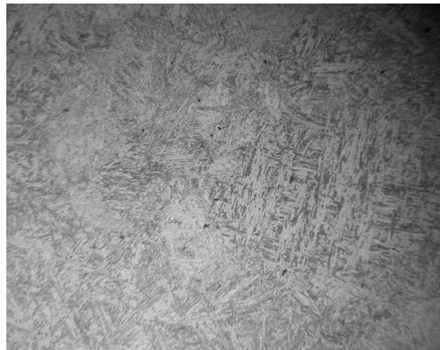
Figure 2. 8# Hot section again weld microstructure 图 2. 8#再热热段焊缝金相组织
