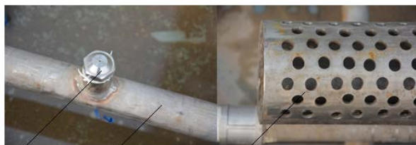
1: 燃烧器; 2: 输油管道; 3: 点火器
