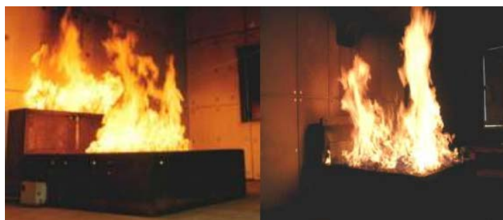
Figure 7. Real map of bed combustion model 图 7. 双人床燃烧模型实景图
