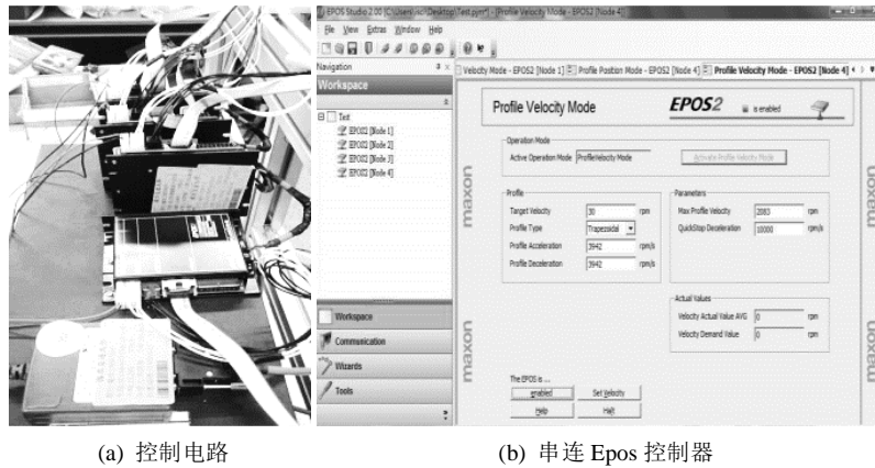
Figure 27. Control circuit of lower extremity exoskeleton robot 图 27. 下肢外骨骼机器人控制电路
