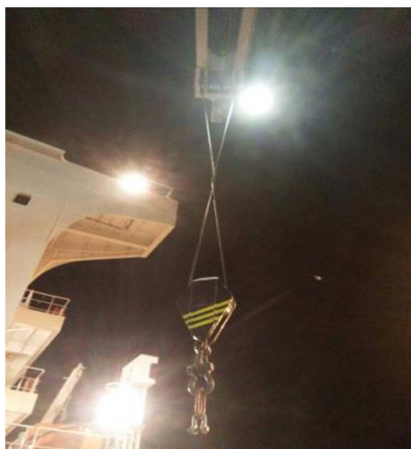
Figure 1. Twisting photos of hoisting wire rope 图 1. 起升钢丝绳打扭现象照片
