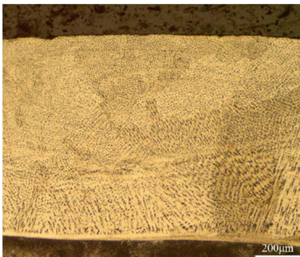
Figure 7. Microstructure of single layer CrMnFeCoNi high-entropy alloy deposition layer 图 7. 单层 CrMnFeCoNi 高熵合金沉积层的显微组织
