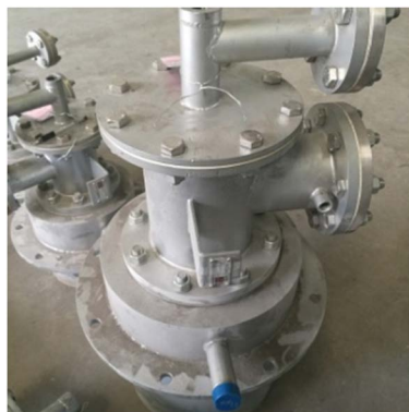
Figure 1. IHVB subhigh speed burner solid chart 图 1. IHVB 型亚高速烧嘴实体图
