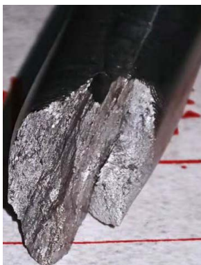
Figure 2. Macro morphology of tensile fracture 图 2. 拉伸断口宏观形貌
