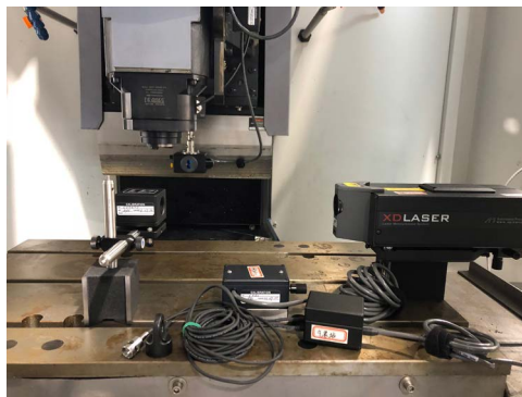
Figure 2. Geometric error detection site 图 2. 几何误差检测现场
