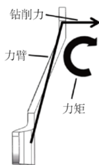
Figure 13. Moment diagram 图 13. 力矩示意图
