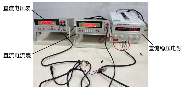
Figure 7. Kelvin four-wire test platform 图 7. 开尔文四线法测试平台
