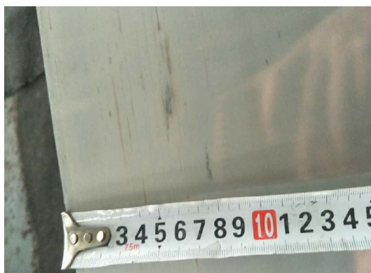
Figure 1. The slight peeling flaw 图 1. 较轻的表面脱皮图
