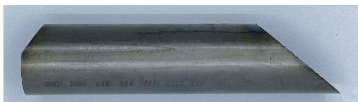
Figure 2. Tube blank cutting 图 2. 管坯下料
