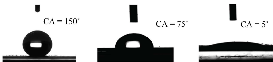
Figure 4. Contact angel of aluminum surface modified by different wettability 图 4. 不同润湿性改性铝表面的接触角
