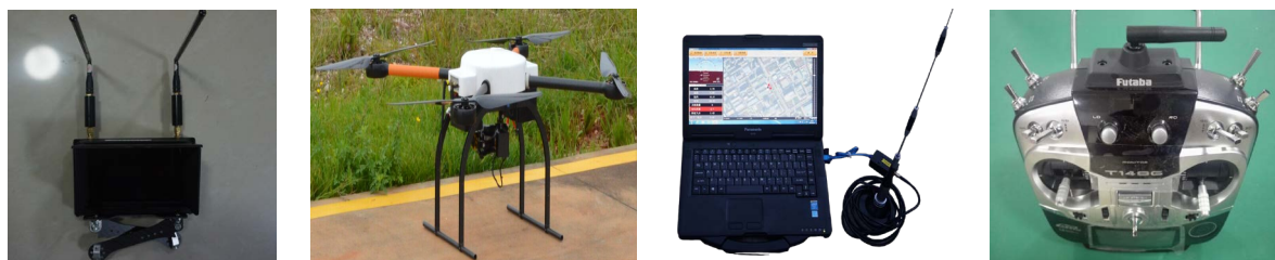
图传设备无人机机体地面站、数传设备遥控器
