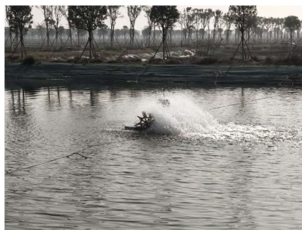
Figure 2. Water cart type aerator installed in the breeding pool 图 2. 育种对照池安装使用的水车式增氧机
