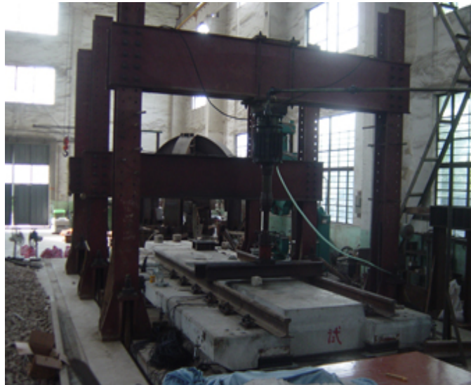
Figure 5. Fatigue experiment 图 5. 疲劳试验现场
