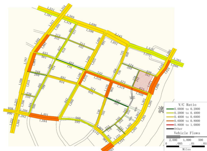
Figure 4. Road section flow saturation map 图 4. 路段流量饱和度图
