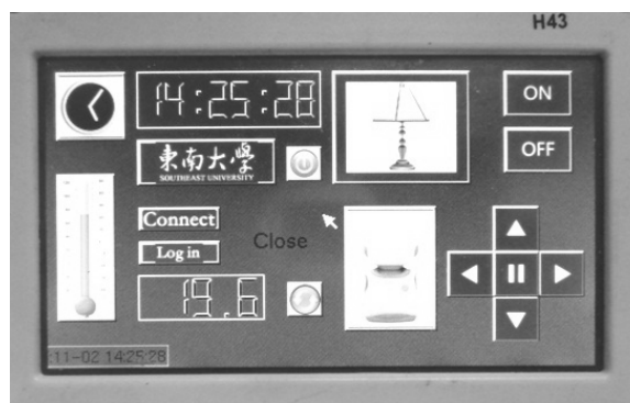
Figure 4. Interface of handheld terminal controller 图 4. 手持终端控制器界面
