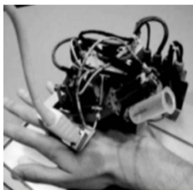
Figure 13. A 6-DOF Venipuncture Robot 图 13. 一种六自由度静脉穿刺机器人
