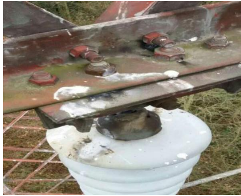
Figure 1. Flashover insulator 图 1. 鸟粪引起闪络的绝缘子
