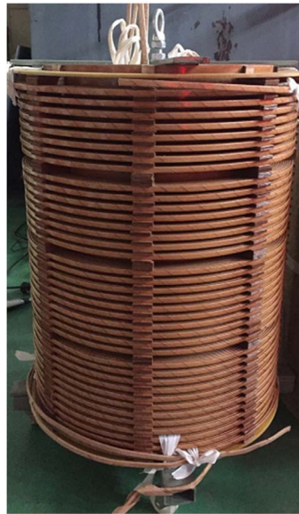
Figure 12. Transformer winding model 图 12. 变压器绕组模型
