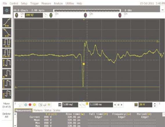
图 13 防护模块输入端脉冲(峰值电压 898 V)
