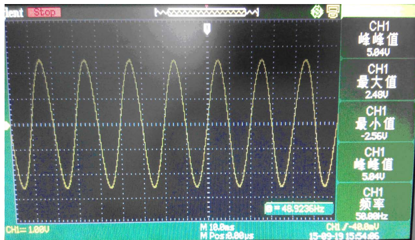
Figure 9. Holzer current sensor output waveform 图 9. 霍尔电流传感器输出波形
