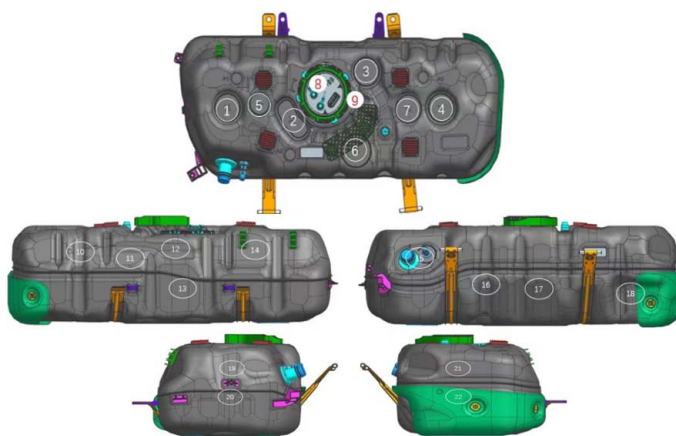
Figure 2. Fuel tank B and schematic diagram of deformation test point 图 2. 燃油箱 B 及形变量测试点位置示意图
