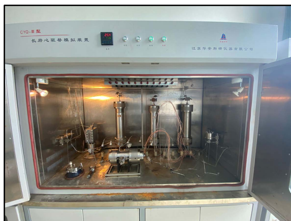
Figure 2. Multifunctional gas-water two-phase displacement system 图 2. 多功能气 - 水两相驱替系统
