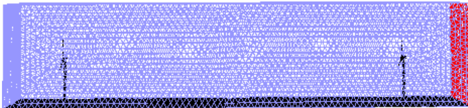
Figure 1. Machine spacing of 8.5 D wind farm modeling diagrams 图 1. 两机间距为 8.5 D 的风场建模图
